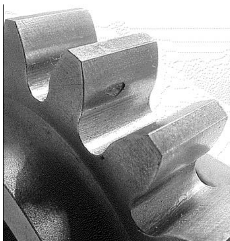
Slika 23. Slika prikazuje "flake pitting" oštećenje na zubu zupčanika [7]
