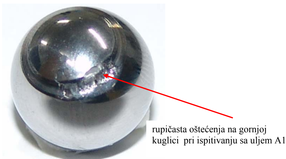
Slika 45. Slika prikazuje rupičasto oštećenje površine kuglice pri mjerenju sa uljem A1
