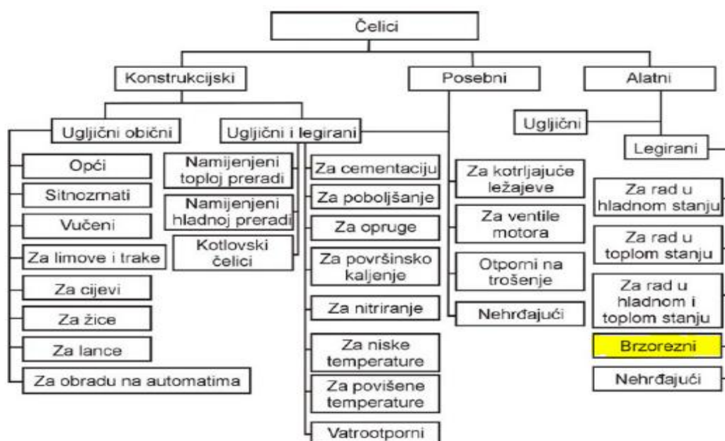
SLIKA 1. Sistematizacija čelika prema namjeni[1]
