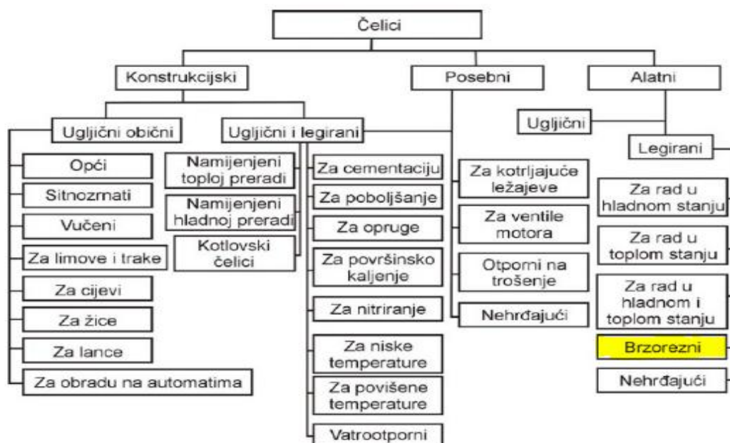
SLIKA 1. Sistematizacija čelika prema namjeni[1]
