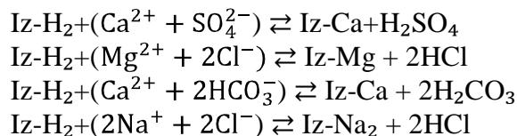
Svi kationi u vodi izmjene se s  $\text{H}^+$  ionima smole te se dobije kisela voda  $\text{pH}=2,8 \div 3$  (dekationirana voda) oslobođena od metalnih iona koja se ne može upotrijebiti kao procesna voda te se mora obraditi sa smolom anionske skupine.
