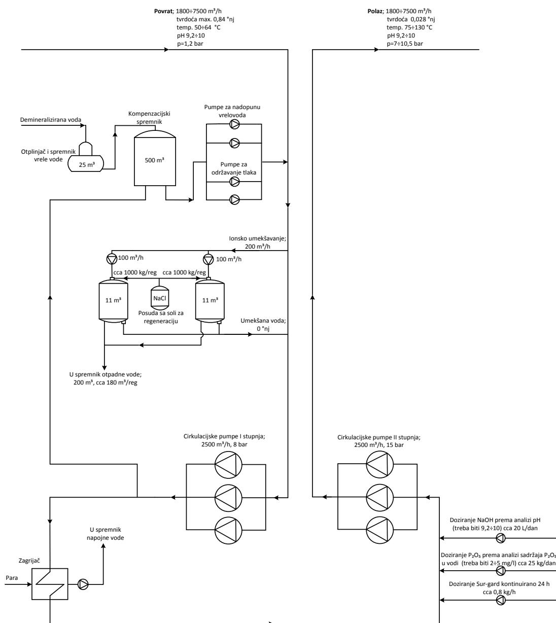
Slika 4. Pojednostavljena shema vrelovodnog sustava TE-TO Zagreb
