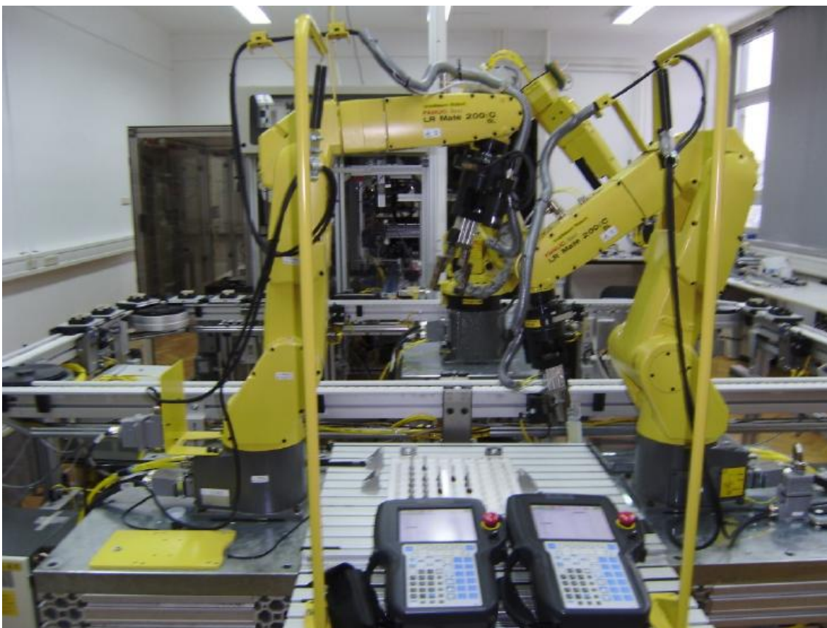
Slika 1.1 Dva robota koji dijele radni prostor. Laboratorij za projektiranje izradbenih i montažnih sustava
