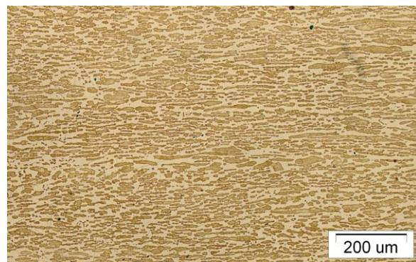
Slika 54. Mikrostruktura uzorka 3 (poprečan na smjer valjanja)
