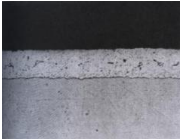
Slika 17. Mikrografski prikaz kontinuiranih trakastih linija [11]
