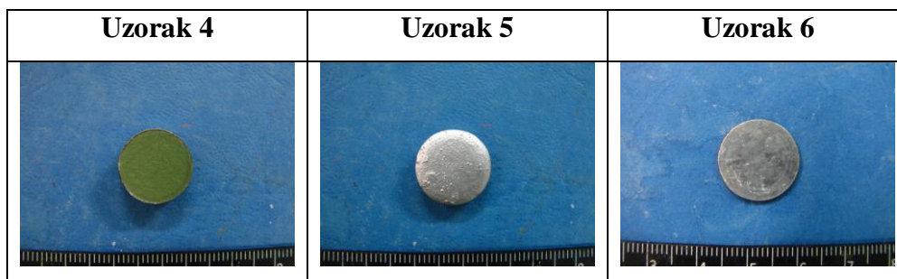
Slika 49. Pocinčani uzorci sa premazima [20]
