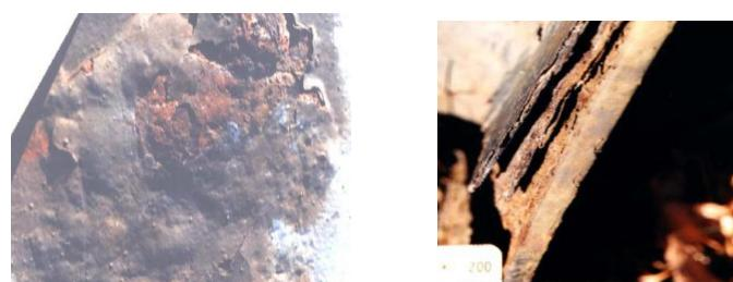
Slika 5. Bubrenje i listanje materijala kod potpovršinske korozije [4]
