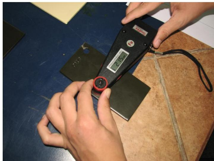
Slika 34. Mjerenje debljine prevlake [20]
