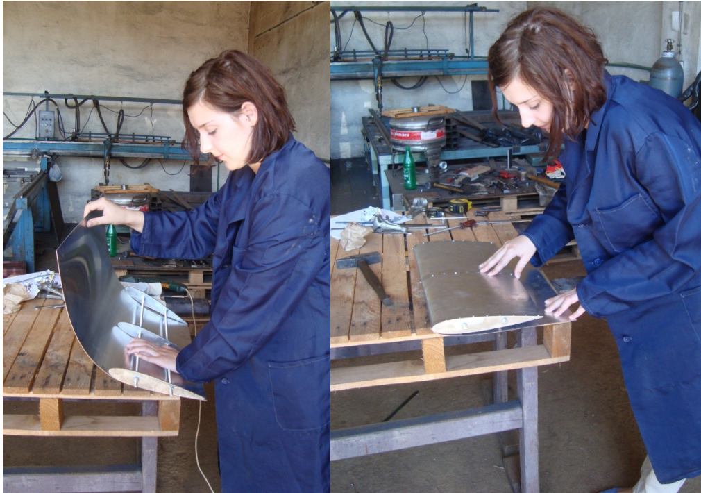
Slika 5. a) Presavijanje oplata oko rebara, b) izgled sekcije krila nakon presavijanja oplata
