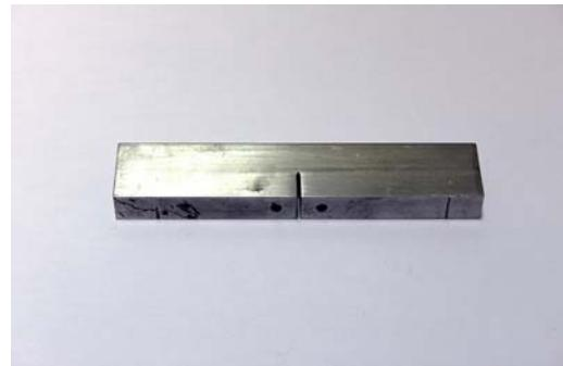
Slika 7.11 Polirana epruveta
