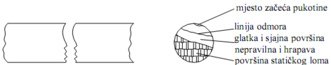
Slika 3.3 Opći izgled površine loma usljed umora materijala
