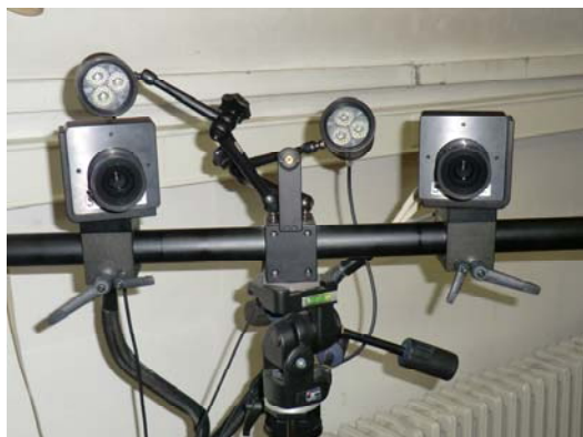
Slika 7.8 a Aramis sustav za snimanje
