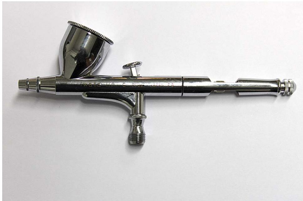
Slika 7.15 Airbrush *IWATA HP-SB PLUS*
