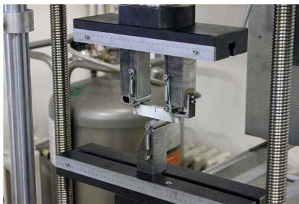
Slika 7.16 Uređaj za savijanje u tri točke
