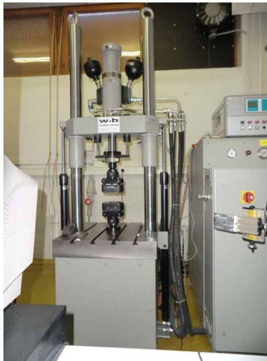
Slika 7.5 Servohidraulička kidalica WALTER+BAI AG
