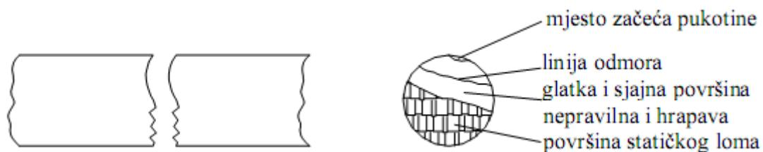
Slika 3.3 Opći izgled površine loma uslijed umora materijala
