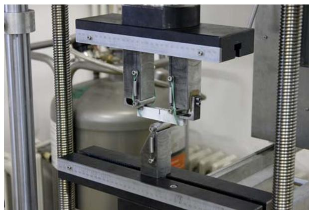
Slika 7.16 Uređaj za savijanje u tri točke
