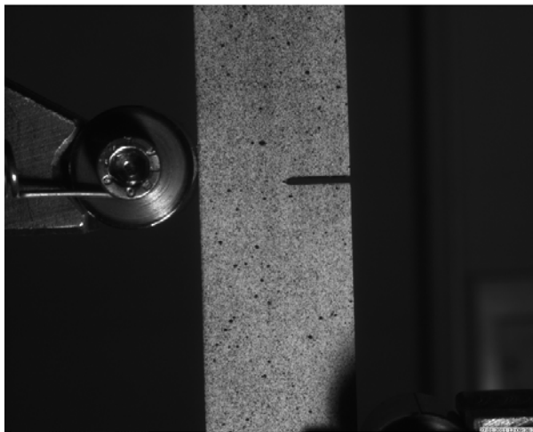
Slika 7.13 Raster za stereometrijsko 3D mjerenje
