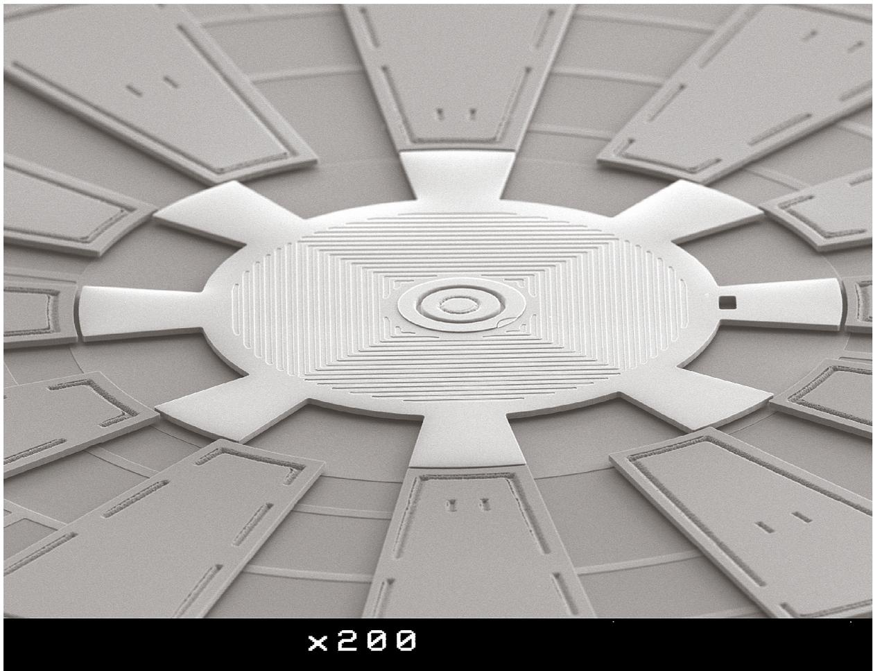
**Slika 3.1.** Polisilicijski mikromotor dobiven površinskim mikrooblikovanjem. [1]
