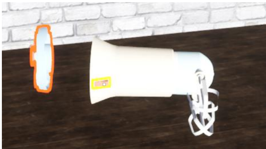
Slika 89. Rastavljanja donjeg dijela kućišta
