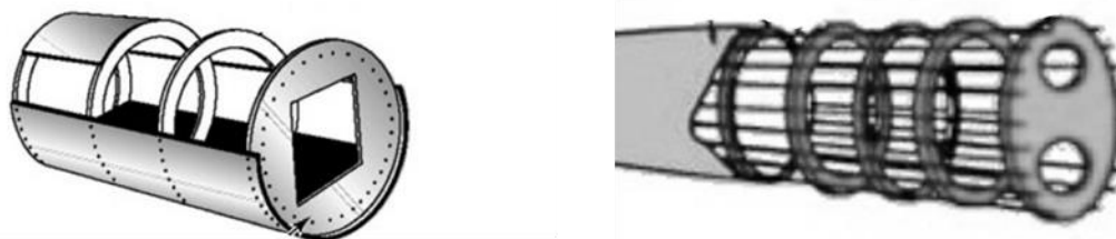
Slika 4. Monokok i semimonokok konstrukcija [3]
