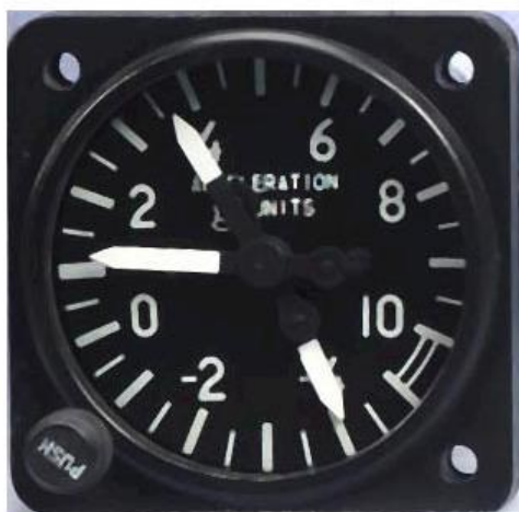
Slika 11. Mehanički akcelerometar u zrakoplovu [13]
