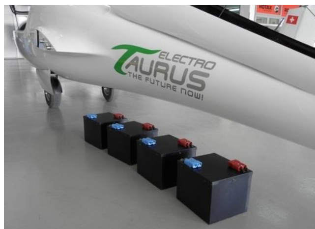
Slika 3.3 Baterije jedrilice Pipistrel taurus electro [11]
