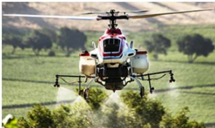
Slika 4. Letjelica s jednim glavnim rotorom prilikom prskanja [15]
