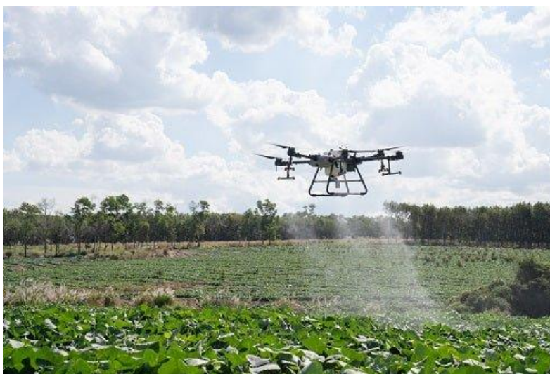
Slika 2. Multi-rotor dron pri prskanju[12]
