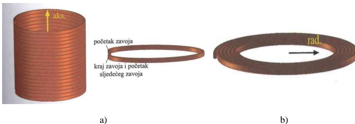
Slika 3. Namatanje: a) aksijalno i b) radijalno [3]
