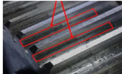
Slika 18. Oštećenje podnožnog dijela zuba gonjenog zupčanika uslijed horizontalnih pomaka[6]
