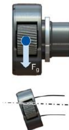
Slika 28. Zakret planeta uslijed nepravilnosti položaja vodila [7]
