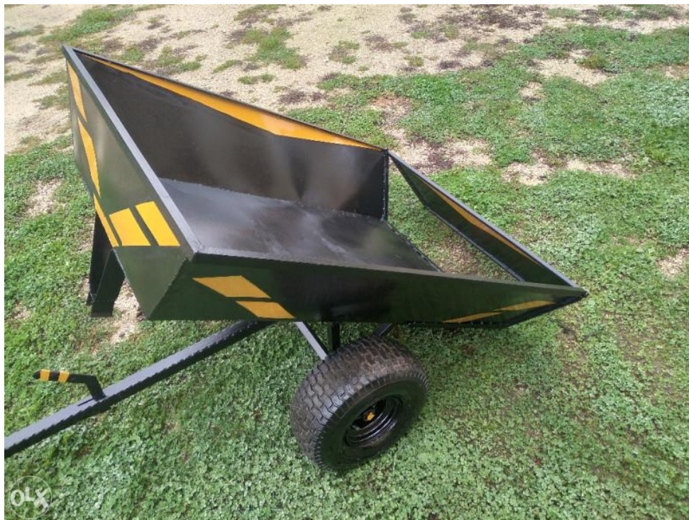
Slika 6. Zavarena izvedba teretnog sanduka
