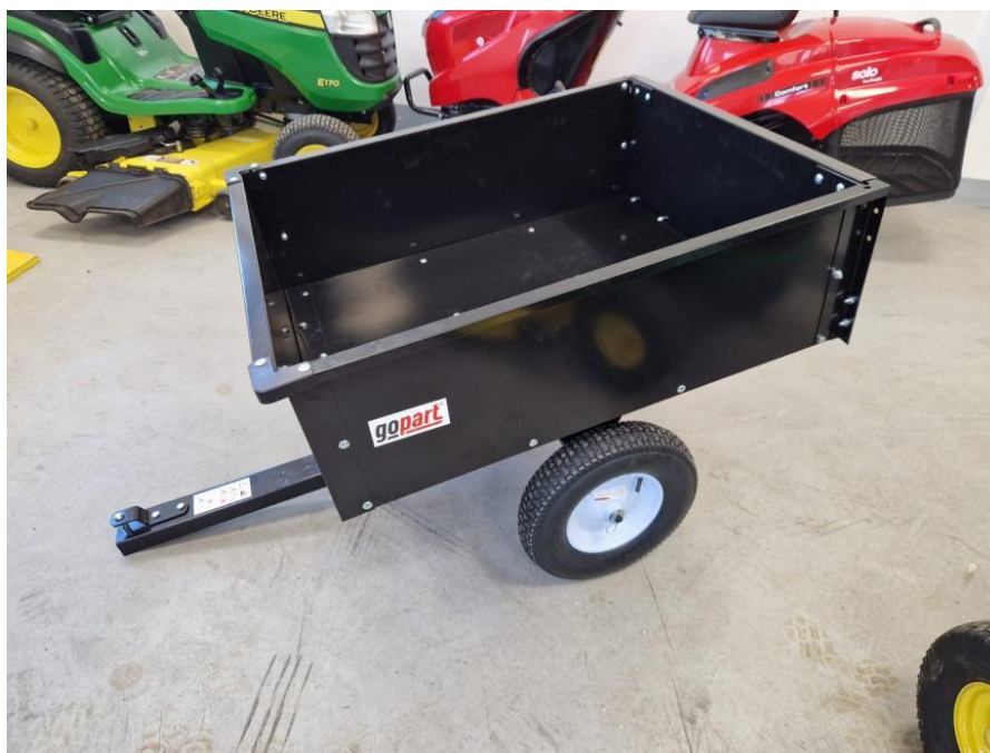
Slika 4. Klasična(vijčana) izvedba teretnog sanduka
