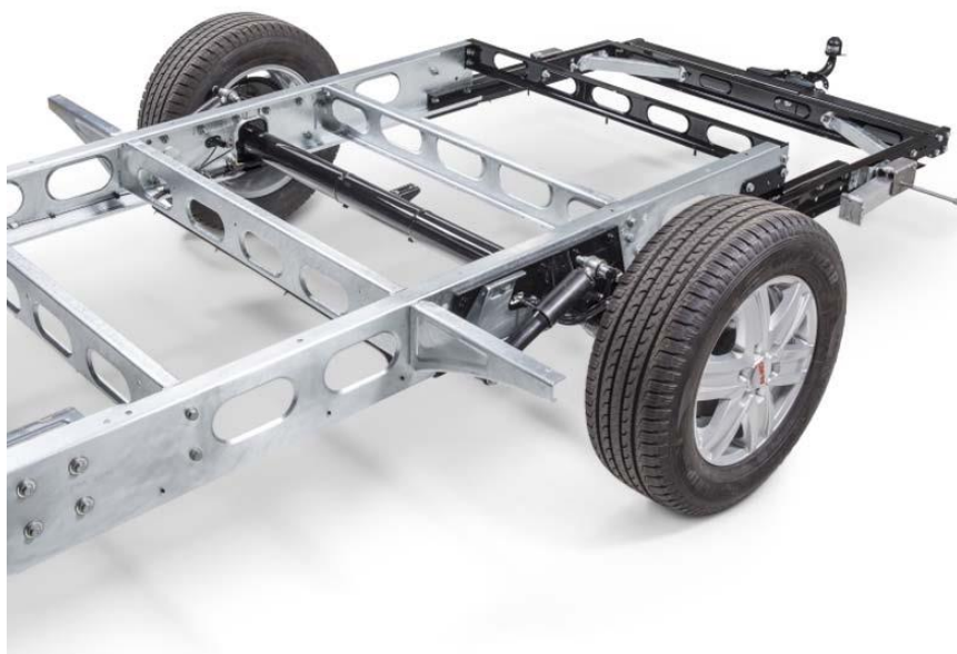
Slika 11. Ovjes sa torzionom osovinom [7]
