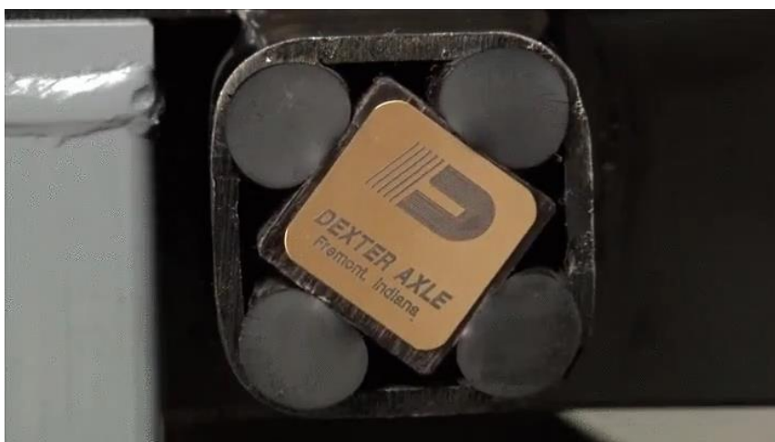
Slika 12. Izgled torzijske osovine iznutra
