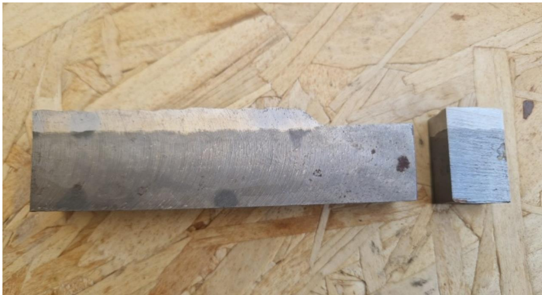
Slika 9. Izrezan uzorak za analizu kemijskog sastava
