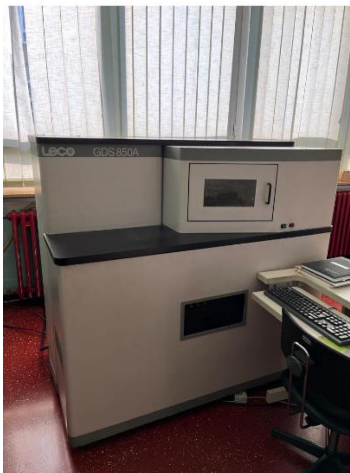
Slika 8. Uređaj za analizu kemijskog sastava GDS 850A-LECO
