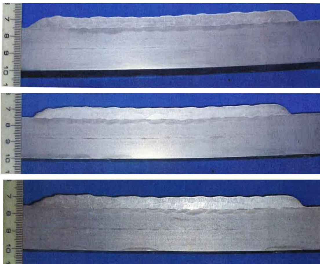
Slika 11. Makroizbrusci čelične ploče s navarenim slojem
