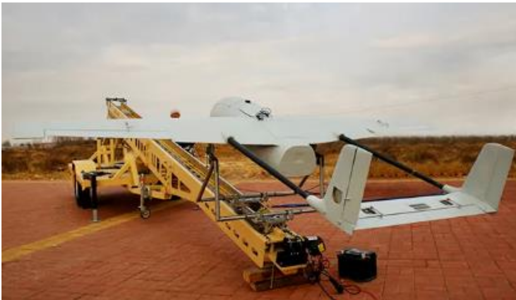
Slika 8. Katapult s pneumatskim sustavom
