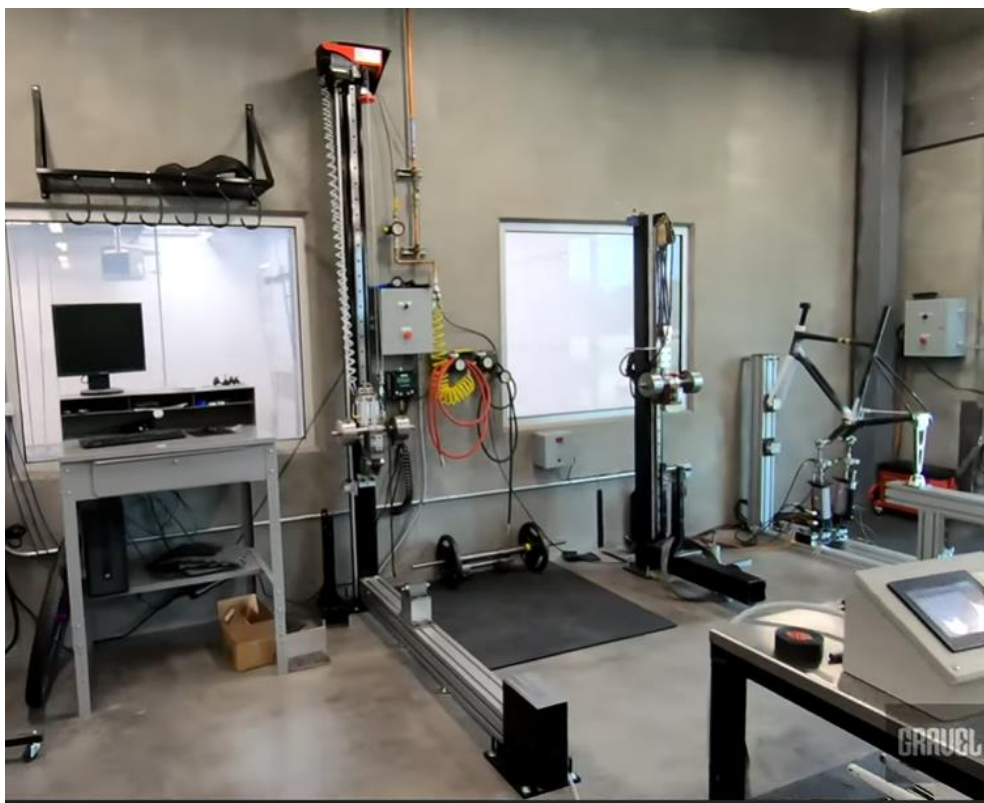
Slika 21 ENVE Composites uređaji za ispitivanje apsorpcije energije
