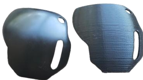
Slika 9 Prikaz PLA prije (desno) i nakon brušenja (lijevo) [15]
