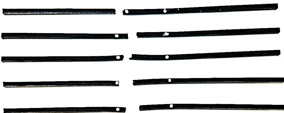
Slika 33 Prikaz ispitanih epruveta od 1,8 mm debljine, 1 mm/min ispitne brzine
