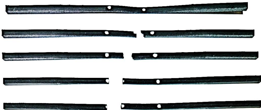
Slika 30 Prikaz ispitanih epruveta od 1,4 mm debljine, 1 mm/min ispitne brzine
