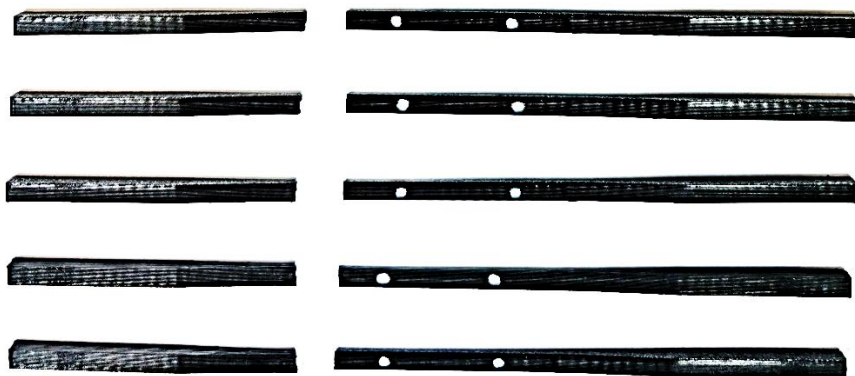
Slika 28 Prikaz ispitanih epruveta od 1 mm debljine, 5 mm/min ispitne brzine
