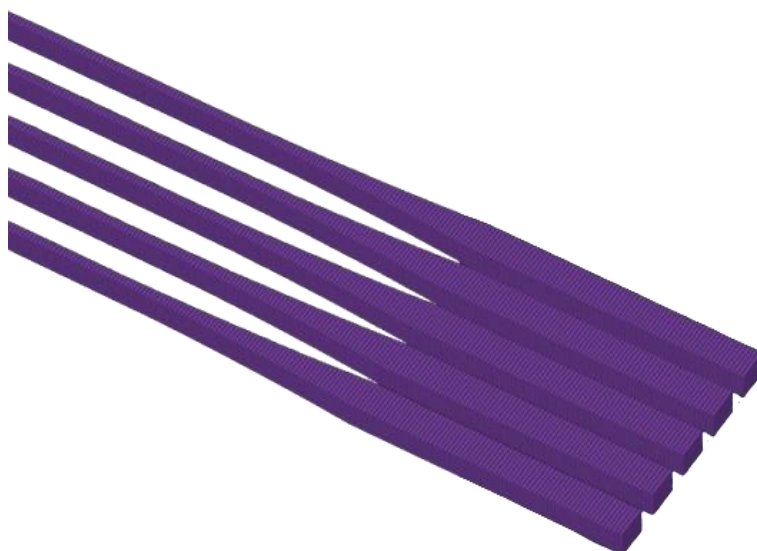
Slika 48 Prikaz poprečnih uzoraka od 1 mm, 0,2 mm visine sloja u programu pisača
