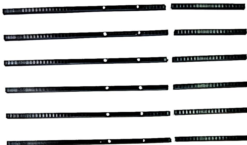
Slika 44 Prikaz ispitanih epruveta od 1,8 mm debljine, 1 mm/min ispitne brzine
