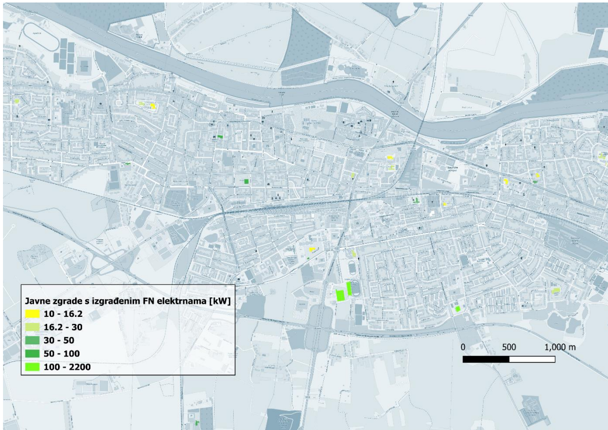
Slika 12 Postojeće/planirane FN elektrane
