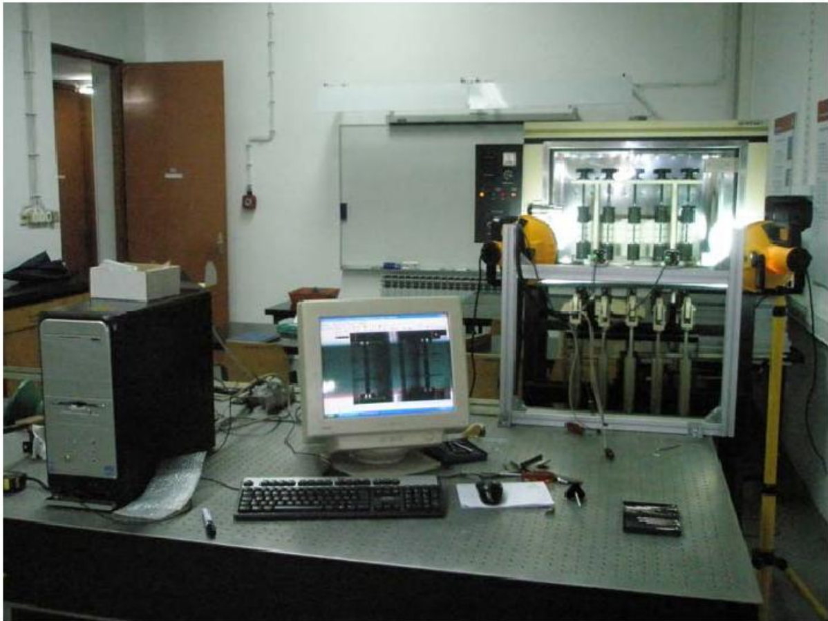
Slika 14 Proces ispitivanja puzanja [3]
