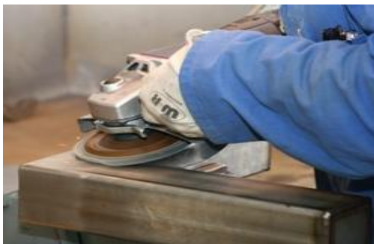
Slika 22. Mehanička obrada nehrđajućeg čelika [49]
