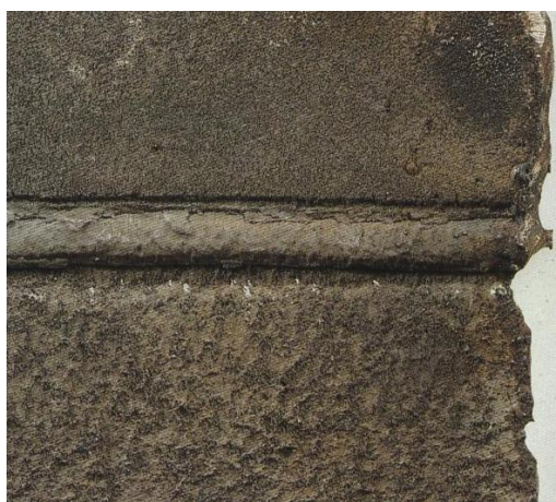
Slika 20. Korozija oblika ureza nožem, iznad zavara AISI 321, ispod zavara AISI 318, dušična kiselina, temperatura 110 do 115°C, dvije godine [47]
