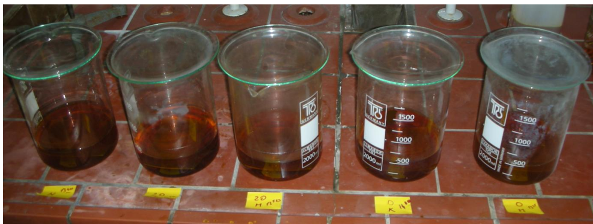
Slika 27. Uzorci uronjeni u otopinu željezo(III)-klorid-heksahidrata – korozijsko ispitivanje otpornosti na jamičastu koroziju
