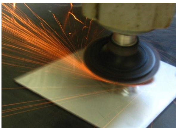
obrada cijelog uzorka brusnim diskom
