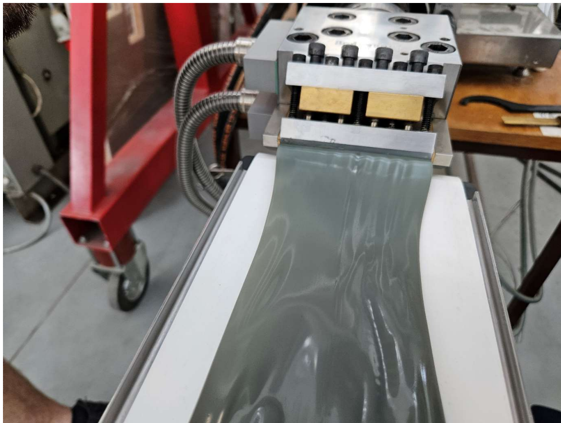
Slika 4.2. Prikaz dobro postavljenog (lijevi dio mlaznice) i loše postavljenog (desni dio mlaznice) razmaka među usnicama širokousne mlaznice
