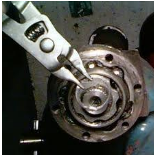
Slika 12. Specijalno uklanjanje sigurnosnog prstena kliještima
