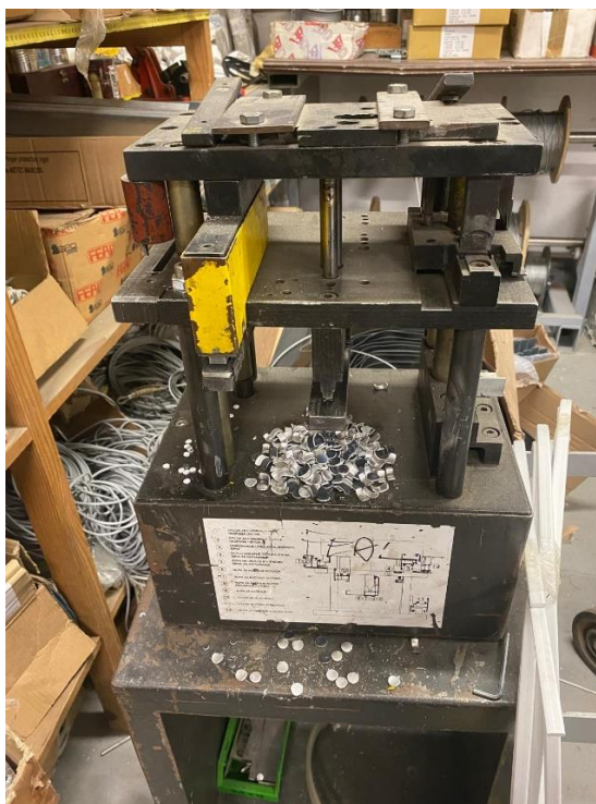
Slika 22. Štanca s vodećim stupovima – Feal
