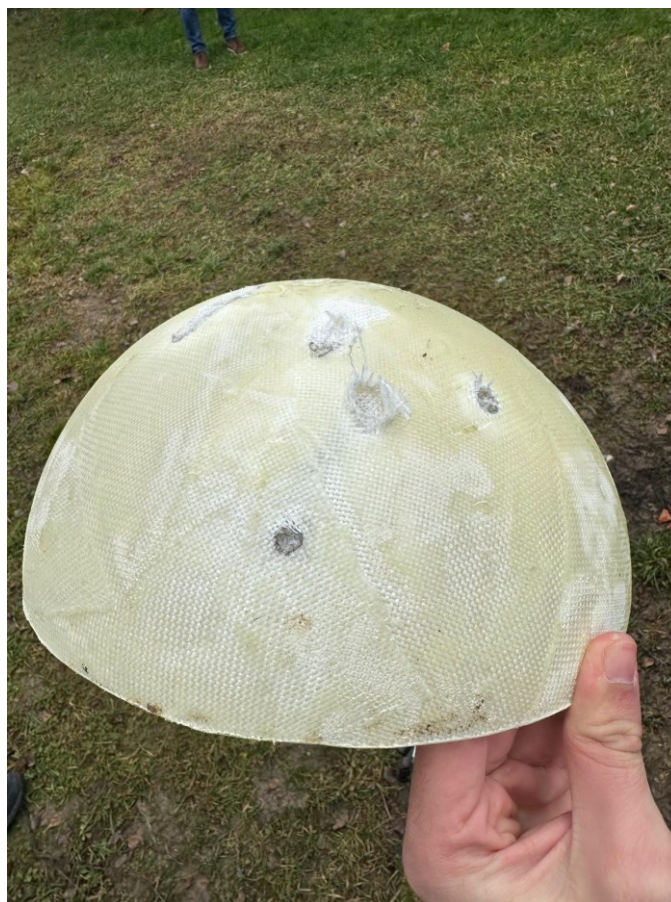
Slika 32. Vanjska strana treće kalote (.38 Special FMJ ravni vrh)
