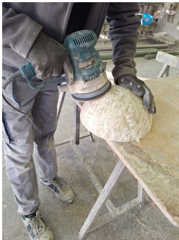
Slika 16. Površinska obrada prve kalote
