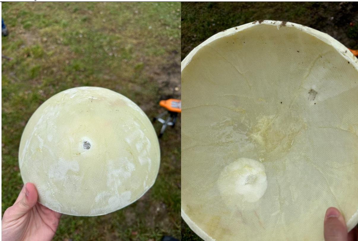
Slika 31. Vanjska i unutarnja strana treće kalote (9 mm)
