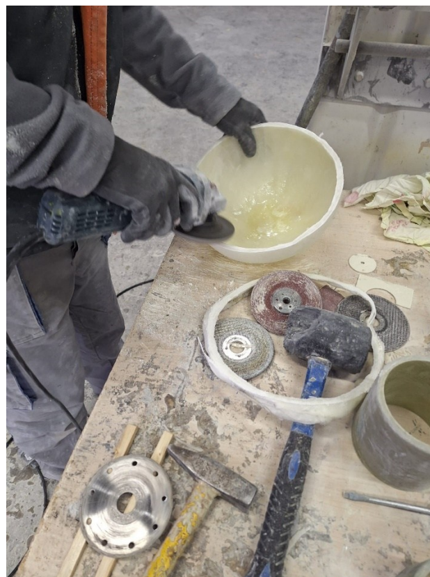
Slika 22. Rezanje i obrada treće kalote
