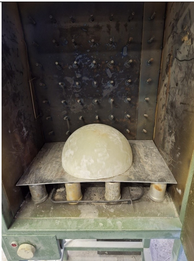
Slika 23. Pečenje treće kalote
