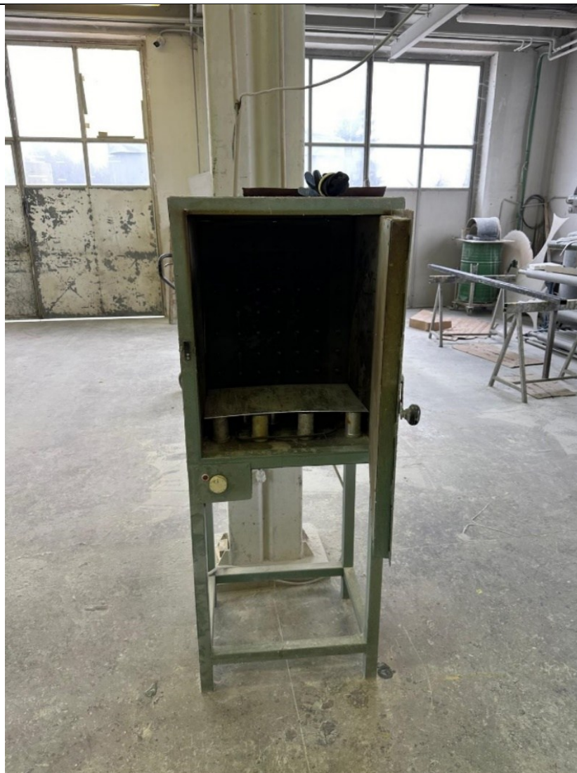
Slika 17. Peć u kojoj su se pekle kalote
