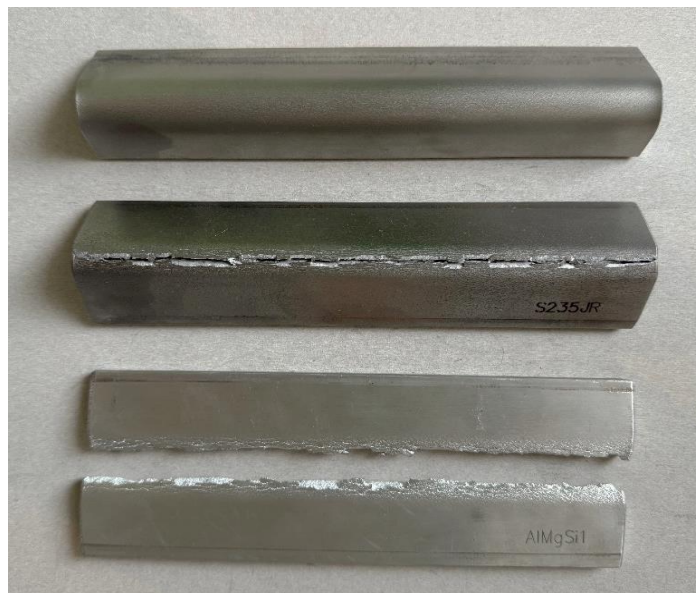
Slika 47. Pukotine na vanjskom radijusu prilikom uzdužnog savijanja
