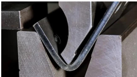
Slika 14. Savijanje lima na kut manji od 90^\circ [14]
