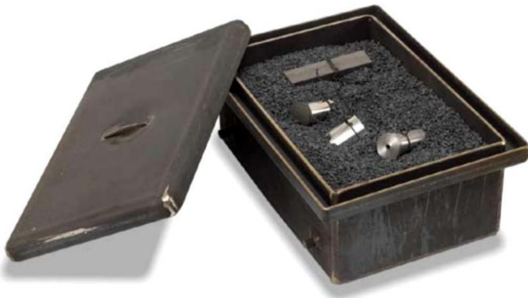
Slika 16. Kutija za boriranje s proizvodima stavljenim u granulat [34]
