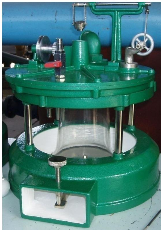
Slika 2. Kućište za Kaplanovu turbinu
