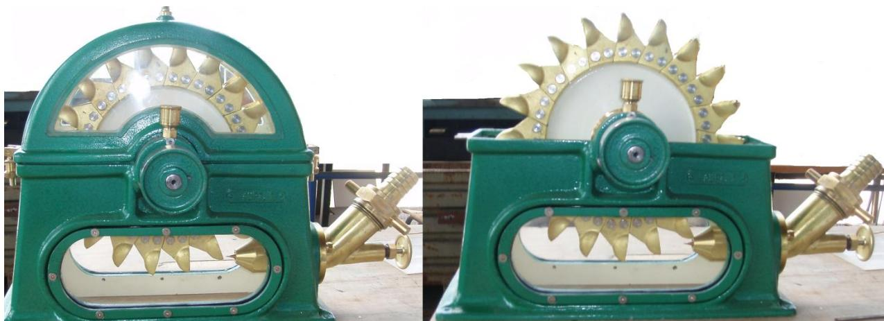
Slika 1. Peltonova turbina
