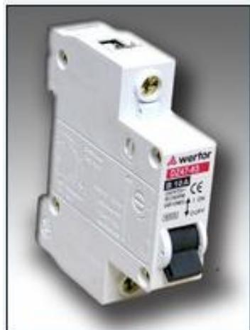
Izabran je magnetski (automatski) osigurač koji je praktičan. U njemu elektromagnet isključuje ugrađenu sklopku kada struja preraste nazivnu vrijednost osigurača. Nakon *ispadanja* takvog osigurača, poslije otklanjanja uzroka preopterećenja dovoljno je polugicu sklopke vratiti u gornji položaj čime se sklopka osigurača opet uključuje što je vrlo praktično.
