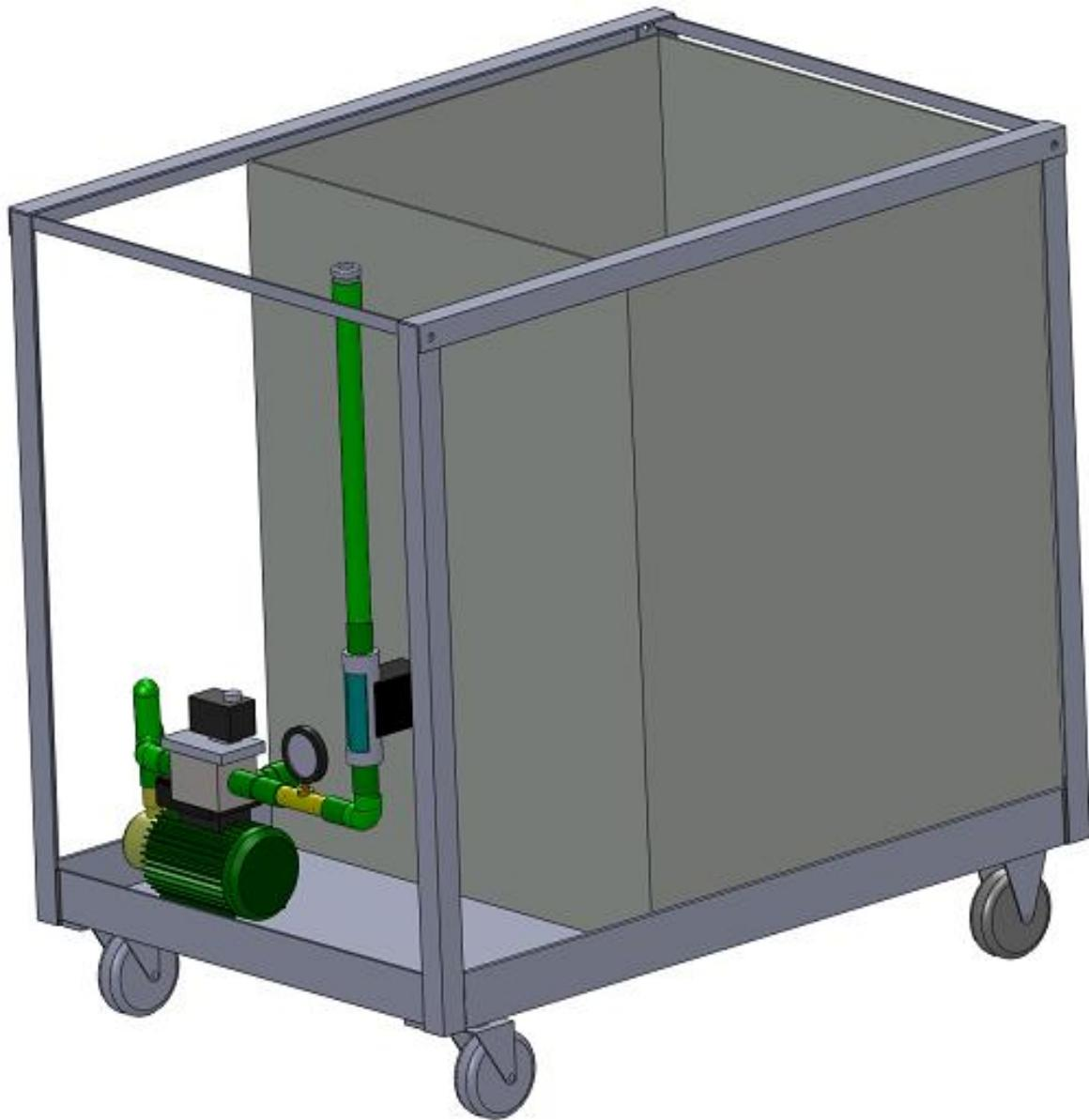
Slika 45. Smještaj cjevovodnog sustava i spremnika u hidrauličkom stolu
