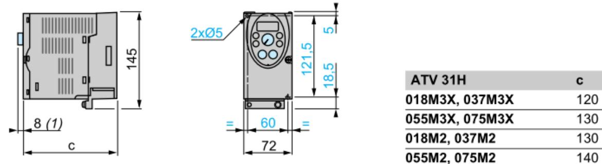
Slika 32. Dimenzije frekvencijskog pretvarača
