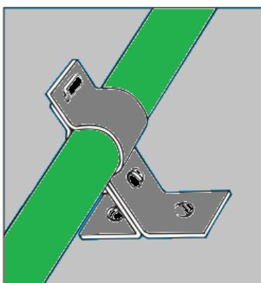
Na podacima o mjernim instrumentima vidljivo je da su elektromagnetski ventil, manometar i protokomjer težine preko 1kg-a, stoga je radi izbjegavanja puknuća cijevi ili odljepljivanje dijelova cjevovodnog sustava potrebno pričvrstiti cijevi oko uređaja na čeličnu ploču hidrauličkog stola.
