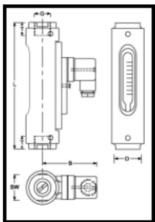
Slika 15. Dimenzije protokomjera
