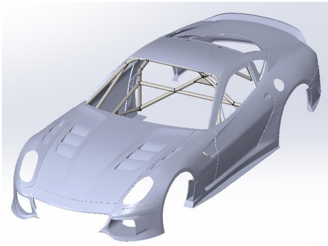
Slika 42. Izometrijski prikaz smještaja zaštitnog kaveza unutar karoserije osnovnog vozila
