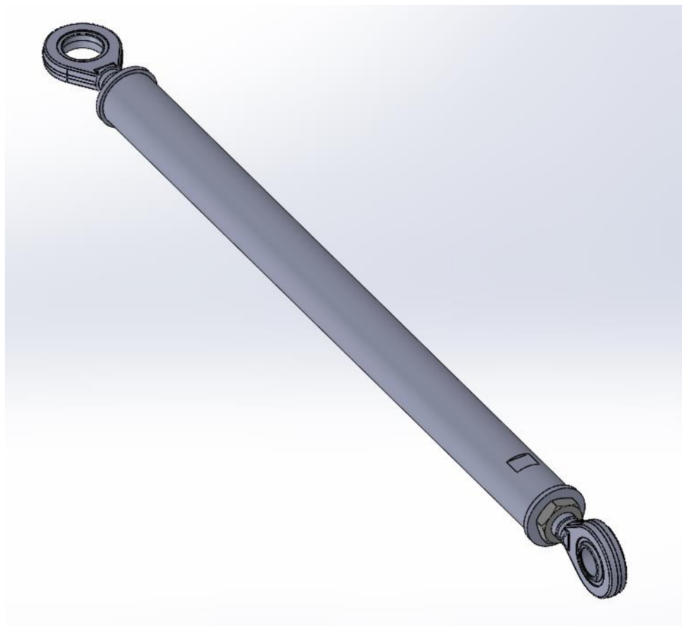
Slika 183. 3D model koncepta „pushroda“
