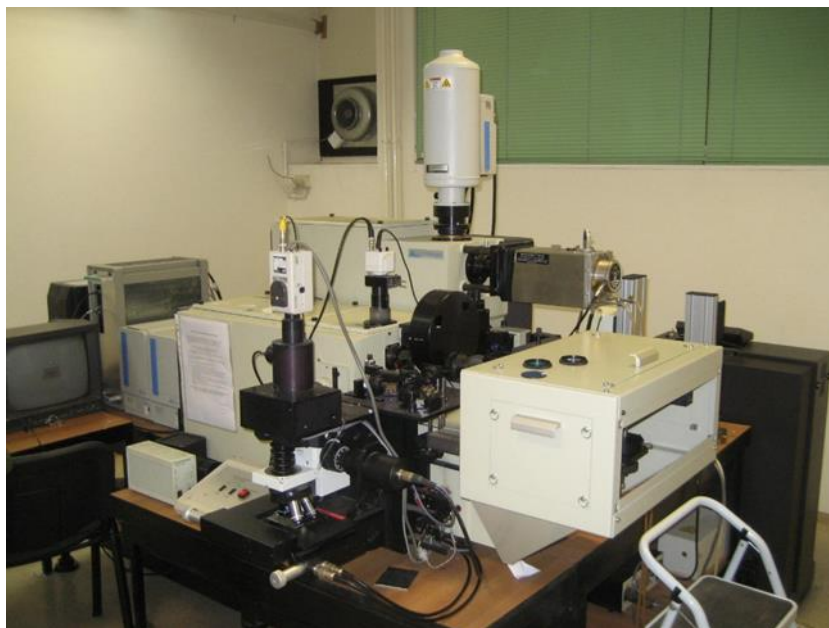
Slika 35 Ramanov spektrometar HORIBA Jobin Yvon T64000.
