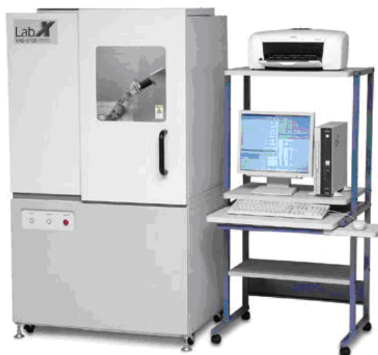
Slika 34 Uređaj za rendgensku difrakciju Shimadzu difraktometar XRD6000.
