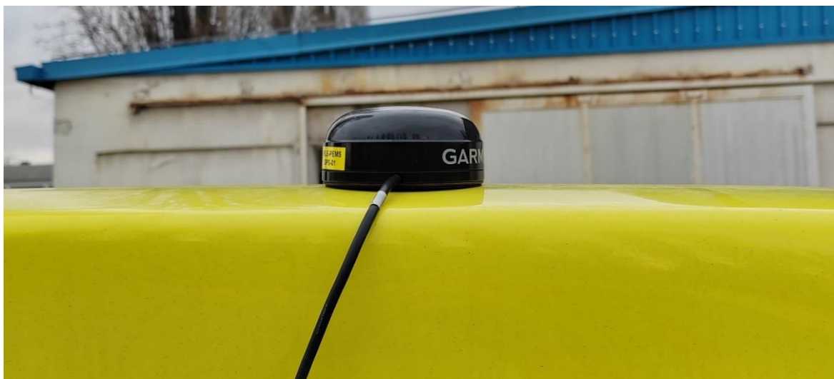
Slika 23. GPS antena postavljena na krov vozila
