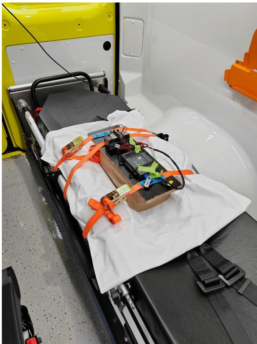
Slika 39. Pozicioniranje mjernog uređaja na nosilu za pacijente
