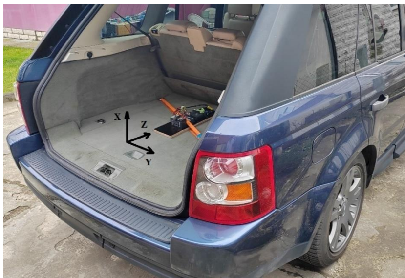
Slika 29. Položaj mjernog uređaja u vozilu Range Rover Sport s ucrtanim koordinatnim sustavom
