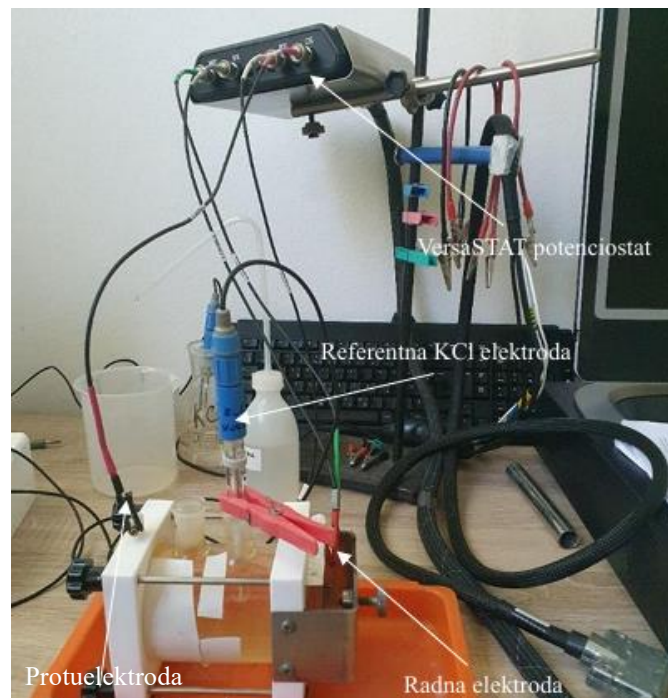
Slika 41. Ispitna elektrokemijska ćelija
