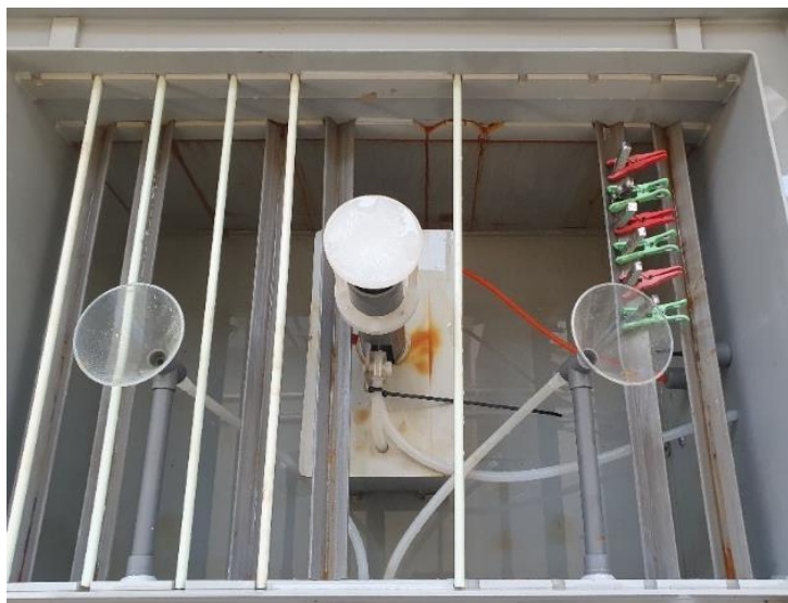
Slika 33. Uzorci postavljeni u slanu komoru
