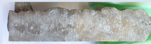
Slika 40. Ispitivanje u slanoj komori na uzorku 23
