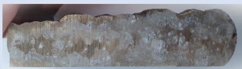
Slika 40. Ispitivanje u slanoj komori na uzorku 23
