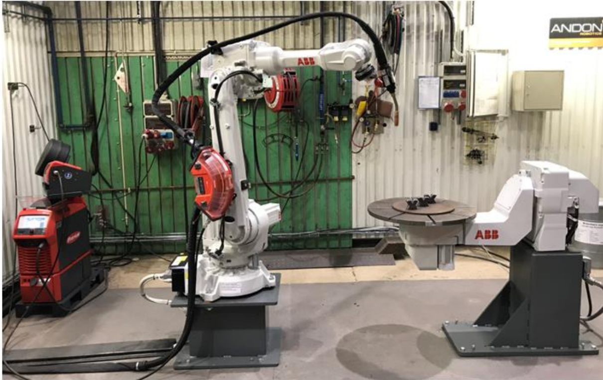
Slika 14. Stanica za WAAM proces [23]
