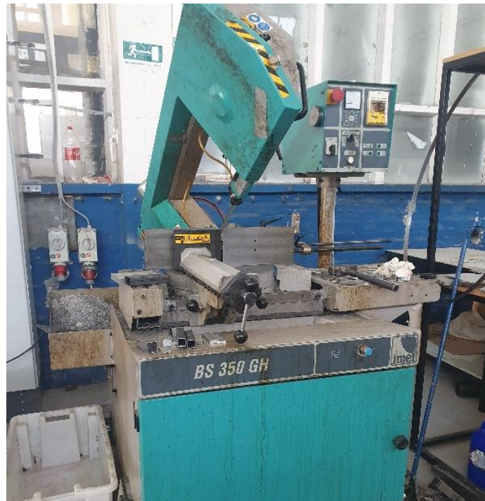
Slika 30. Pila korištena za rezanje uzoraka
