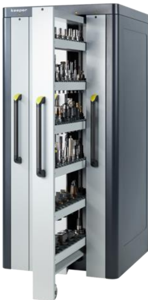
Slika 33. - Zollerov "Keeper" pametni ormar za upravljanje alatima [18]
