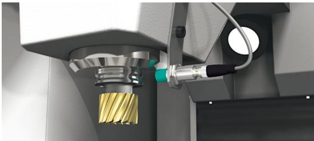
Slika 25. - RFID čitač u obradnom centru [18]
