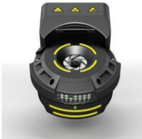
Slika 11. - Indukcijska zavojnica za termo – stezanje [2]
