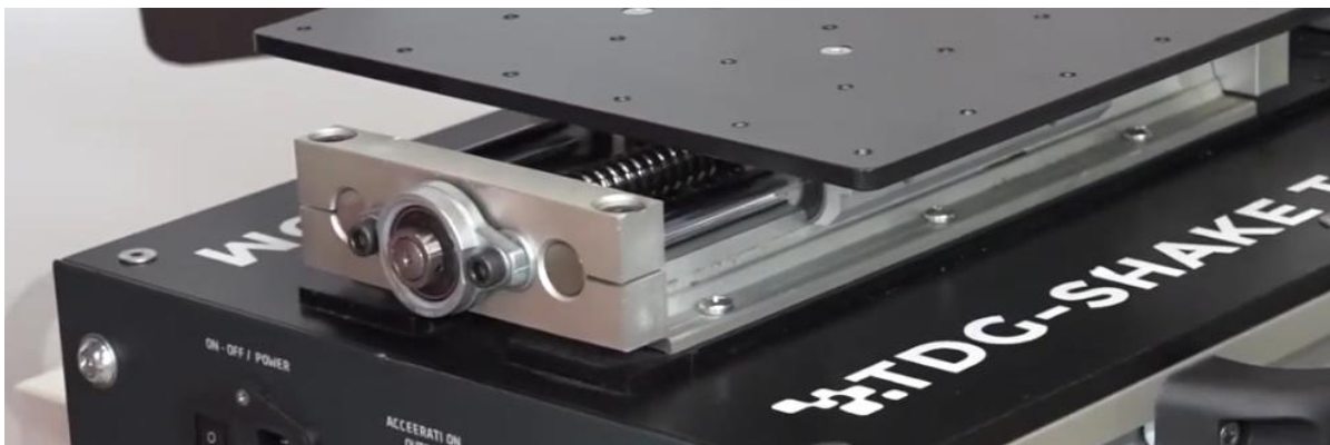
Slika 14. Izvedba pomicanja platforme ATOM, DTG [6.]
