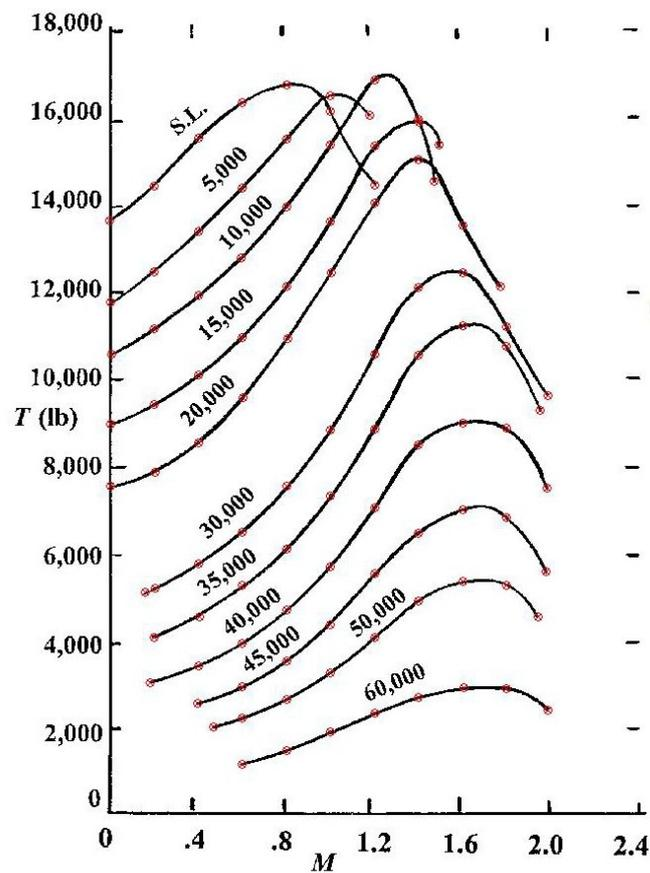
Slika 4.2: Izmjerena karakteristika F404-GE-400 (anglosaksonske jedinice)
