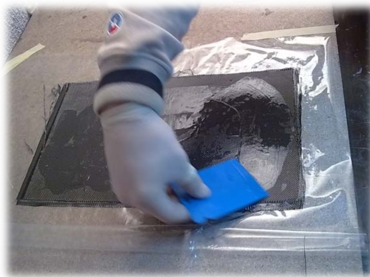
Slika 20. Izrada kora sendvič kompozita
