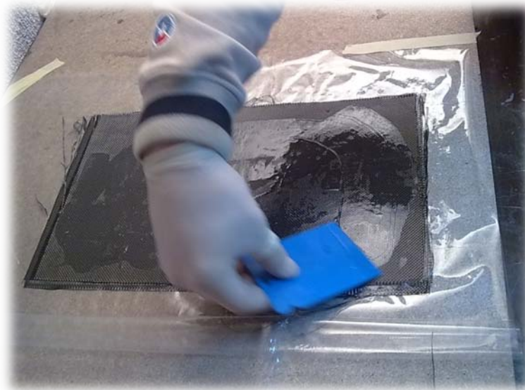
Slika 20. Izrada kora sendvič kompozita
