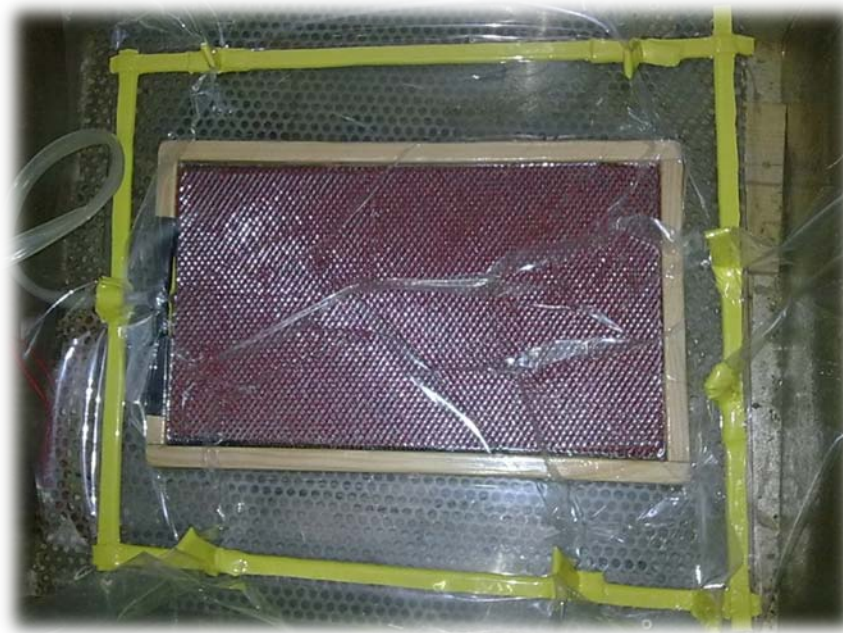
Slika 22. Proces vakuumiranja sendvič kompozita
