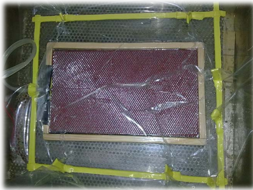
Slika 22. Proces vakuumiranja sendvič kompozita
