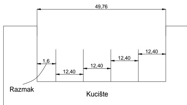
Slika 7. Razmak između kućišta i prvog dijela
