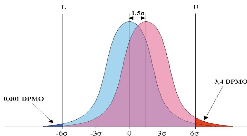
Slika 2. Six sigma process (pomak od  $1,5\sigma$ )
