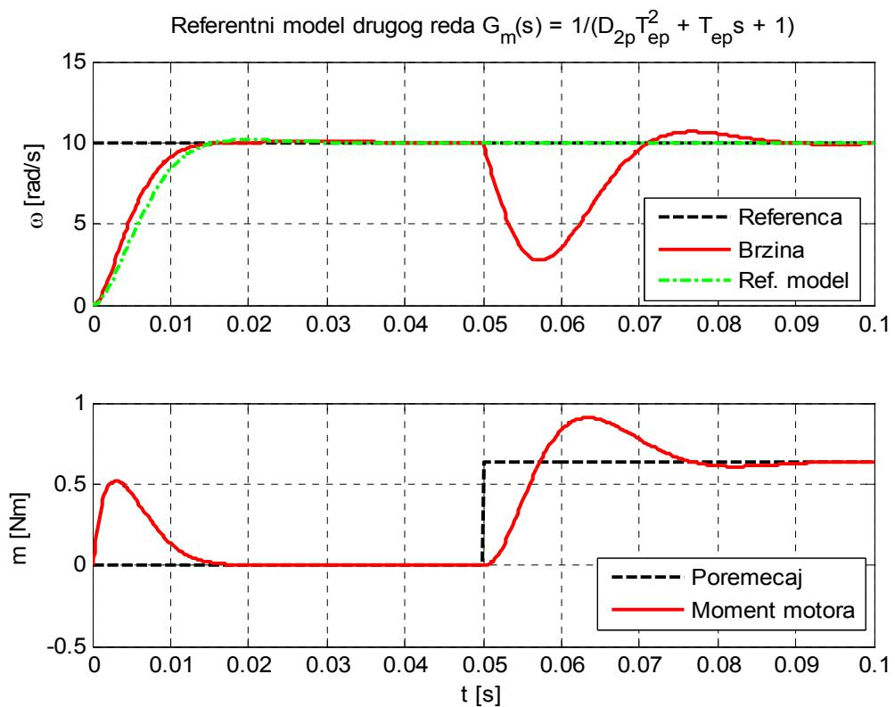
Slika 17. Odziv dualnog regulatora sa ref. modelom 2. reda s postavljenim karakterističnim odnosima
