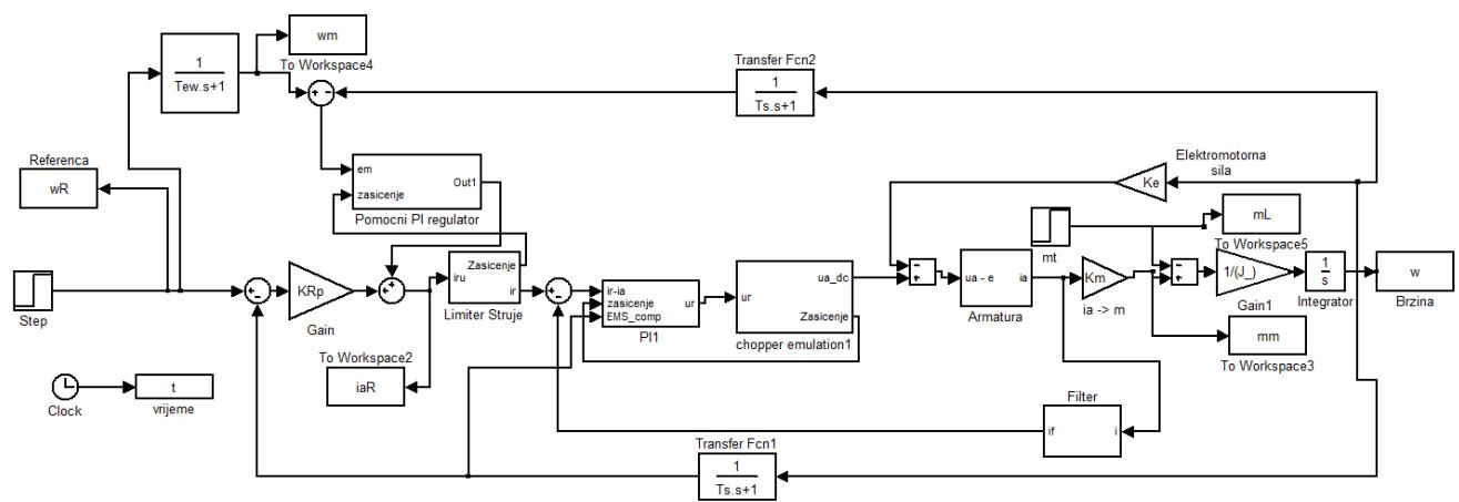
Slika 12. Simulink model dualnog regulatora
