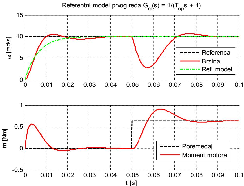
Slika 16. Odziv dualnog regulatora s ref. modelom 1. reda sa postavljenim karakterističnim odnosima
