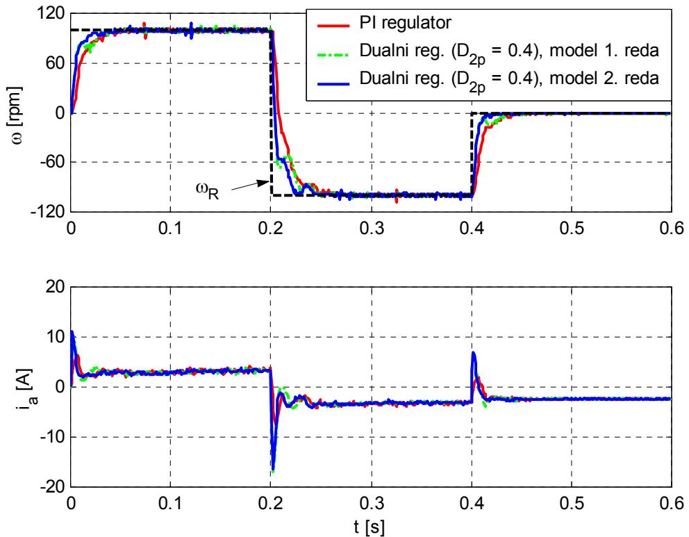
Slika 33. Eksperimentalni rezultati mjerena brzina i struje armature
