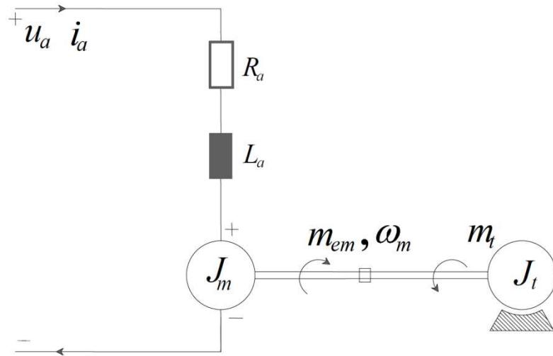
Slika 1. Nadomjesna shema istosmjernog motora s permanentnom uzbudom
