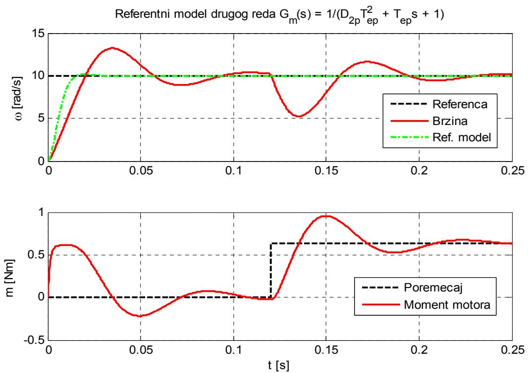
Slika 22. . Odziv dualne strukture (ref.mod. 2. reda) sa povećanom inercijom motora ( $J=3J_n$ ) i postavljenim karakterističnim odnosima  $D_{2p} = 0.4$ ,  $D_3 = D_2 = 0.5$
