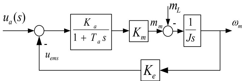
**Slika 2. Blokovski dijagram istosmjernog motora s permanentnom uzbudom**
