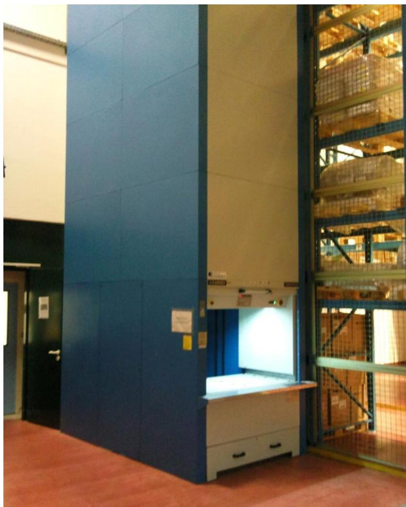
*Slika 15. Vertikalni podizni modul – Shuttle 2*
