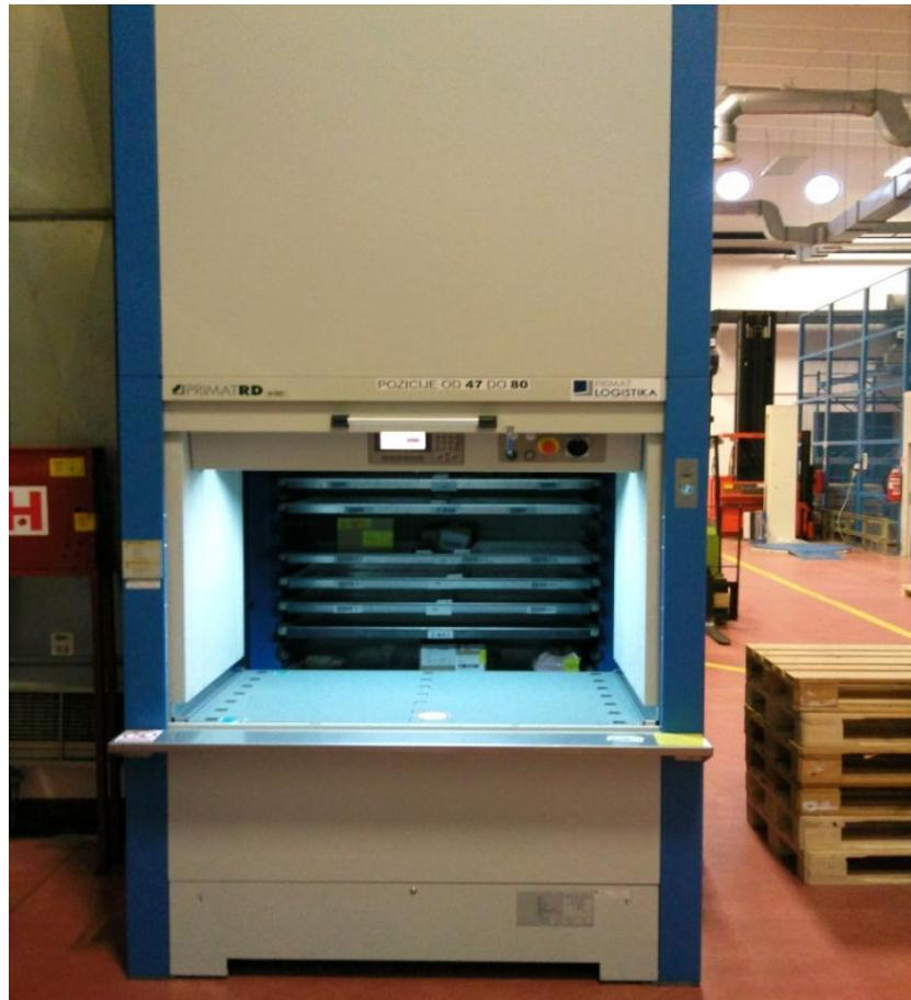
Slika 14. Vertikalni podizni modul – Shuttle 1.
