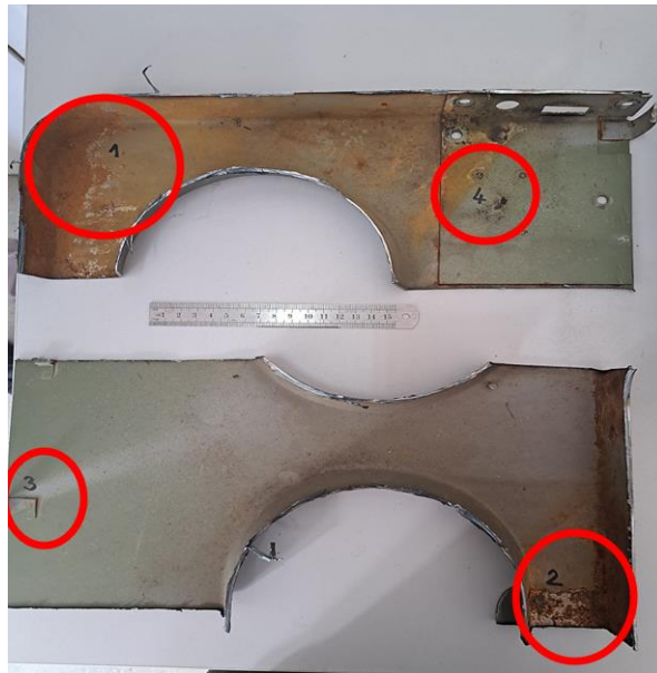
Slika 72. Oblici korozije na unutrašnjoj strani lima vrata vozila
