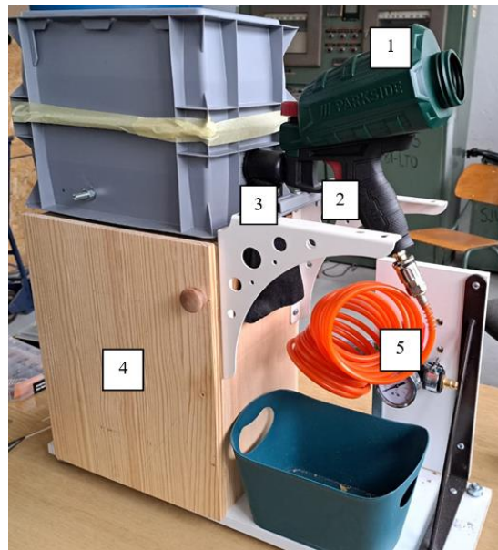
Slika 30. Uređaj za erozijsko ispitivanje: 1 – zračni pištolj za pjeskarenje, 2 – okidač, 3 – vreća za prikupljanje materijala za pjeskarenje, 4 – kontejner medija za pjeskarenje, 5 - manometar
