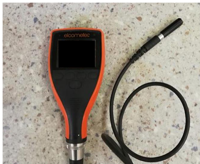
Slika 57. Uređaj za mjerenje debljine suhog filma „Elcometer 456“
