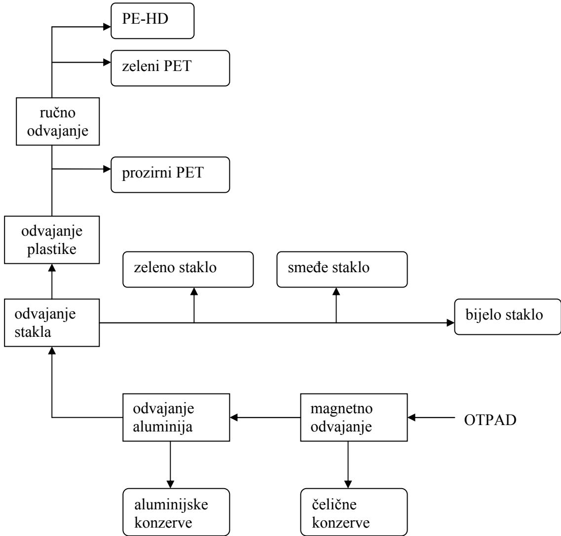
Slika 3.3. Polumehanizirano odvajanje i razvrstavanje plastike [5]
