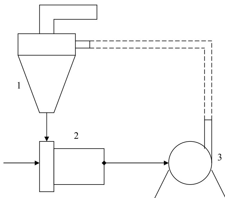
Slika 3.8. Pročišćavanje hidrociklonom: 1 - hidrociklon, 2 - priprema suspenzije, 3 – pumpa
