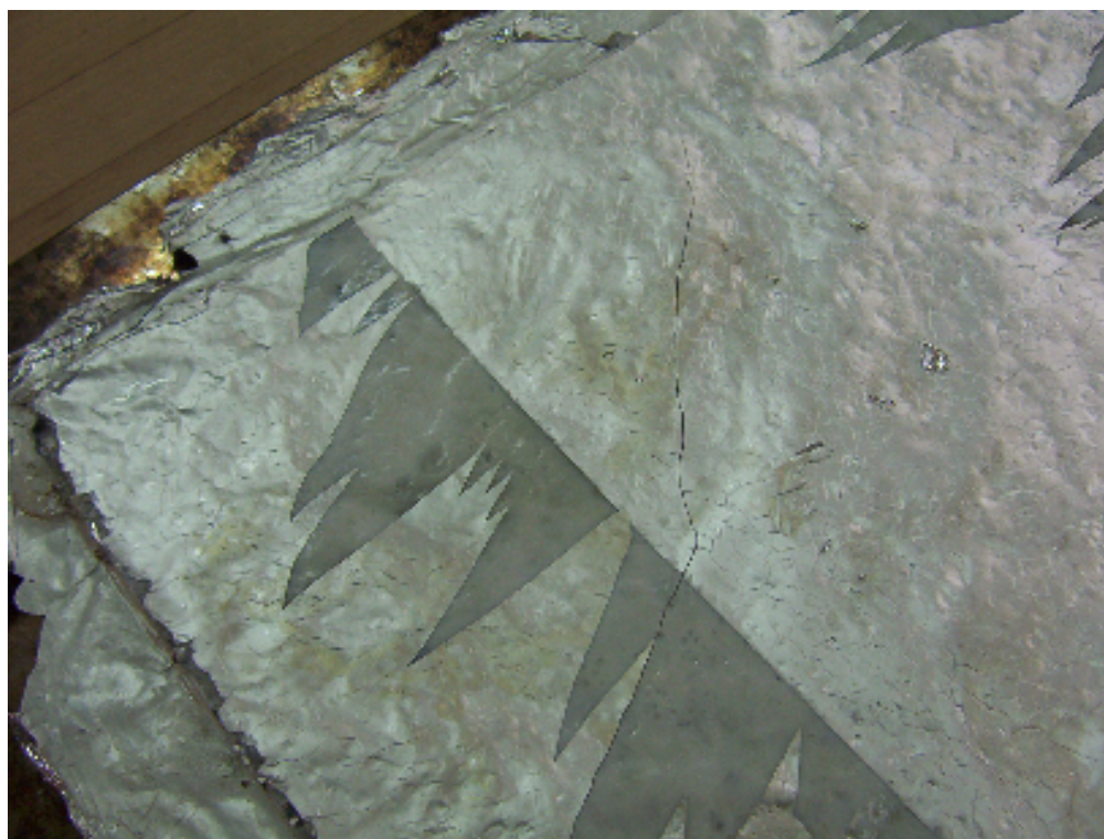
Slika 5.7. Otpresak hlađen vodom
