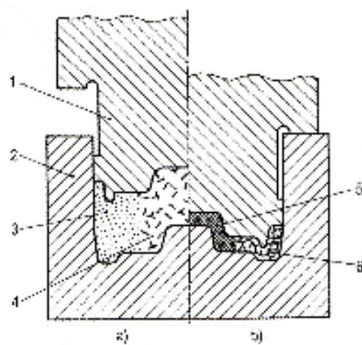
Slika 2.1. Načelo izravnog prešanja; a - početak praoblikovanja, b - završno praoblikovanje, 1 - žig, 2 - gnjezdo, 3 - duromerni prepolimer, 4 - amorfna struktura duromernog prepolimera, 5 - duromerni otpresak, 6 - umrežena struktura duromernog otpreska
