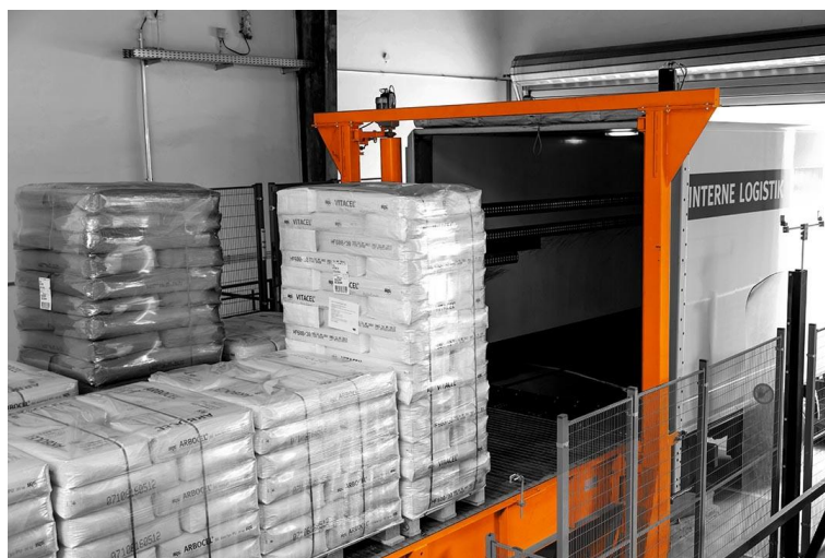
Slika 2.12 Sustav ukrcanja i iskrcaja kamiona tvrtke FAB
