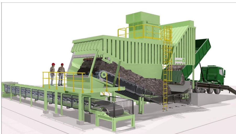
Slika 2.11 Sustav istovara tvrtke Loesche group
