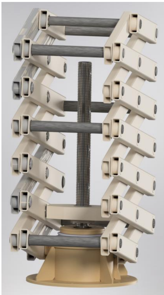
Slika 9. 2 Prikaz vretena i spoja sa škarama
