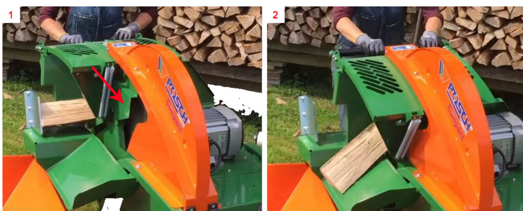
Slika 2.11: Proces rukovanja uređajem s cirkularnom pilom [19]
