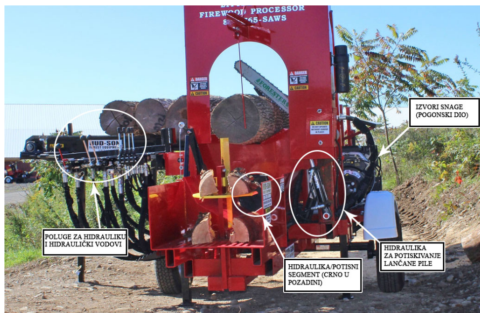
Slika 2.3: Uređaj 'Brute processor 23' - istaknuta hidraulika [13]
