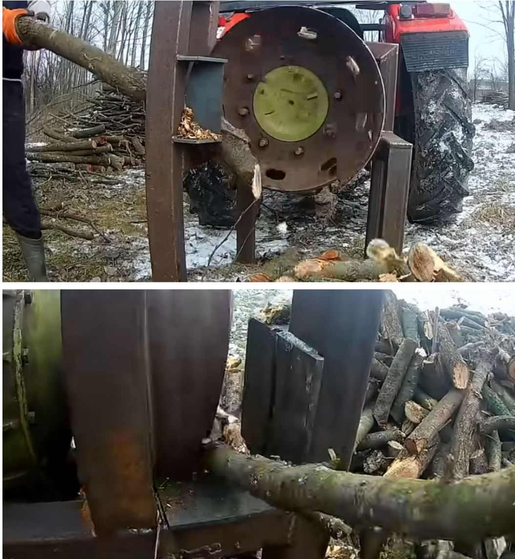
Slika 2.15: Princip rada cjepača s reznim bubnjem [21]
