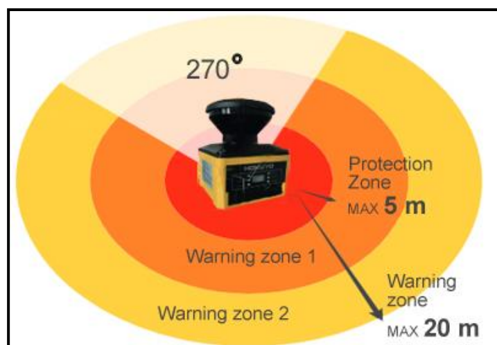
Slika 17. Sigurnosna polja senzora Hokuyo UAM [26]
