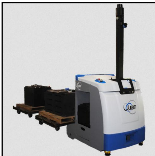
Slika 2. Vučni AGV (JBT Corporation) [19]
