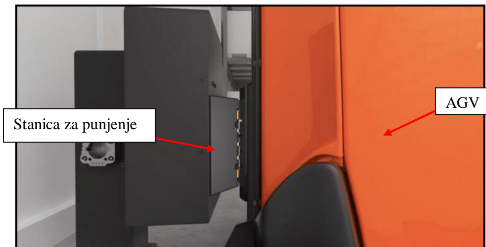
Slika 7. Automatsko punjenje baterija [20]
