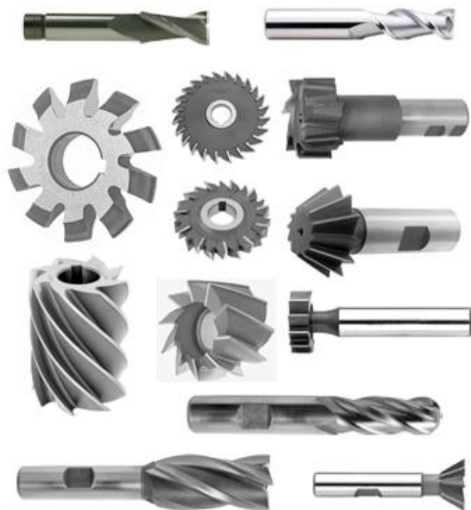
Slika 29. Glodala izrađena iz jednom komada [8]
