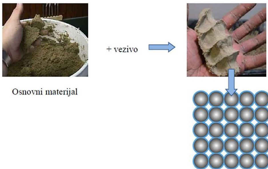
Slika 36. Povezivanje zrnaca pijeska dodatkom veziva [1]
