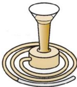
Slika 11. Metoda spiralne probe
