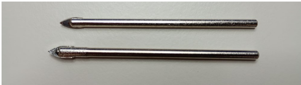
Slika 42. Svrkla bez žlijeba, s dvije oštrice
