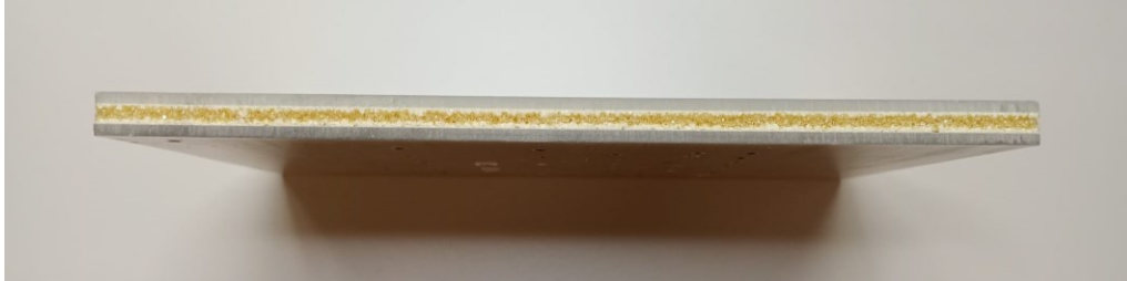
Slika 26. Troslojna struktura Sawbones sintetske kosti
